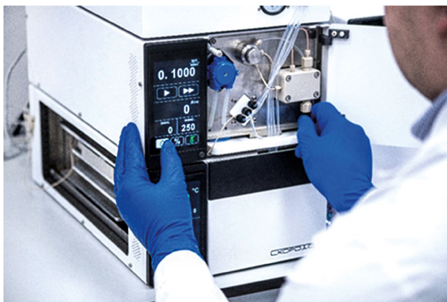
Рисунок 5. Модуль постколоночной дериватизации и насос для подачи элюента
