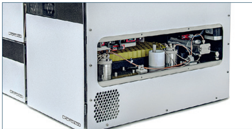
Рис.4. Съемная боковая панель автодозатора "Скороход" с доступом к обслуживаемым узлам
