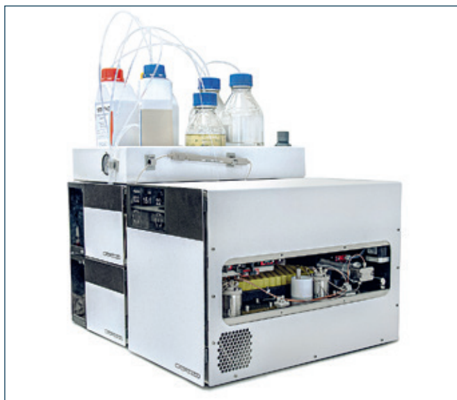
Рис.1. Автоматический дозатор ВЭЖХ "Скороход" с прямым дозированием пробы (split-loop)
