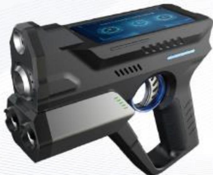
В основе работы устройства лежит технология GS. GS-реагент распыляется на поверхность биологического образца, при этом катионные GS-молекулы вступают в электростатическое взаимодействие с анионными биомолекулами (аминокислотами), в результате чего происходит накопление GS-молекул на боковых цепях аминокислот, что позволяет визуализировать и точно выделить биологические образцы (ДНК) при их освещении с помощью источника возбуждающего света.
